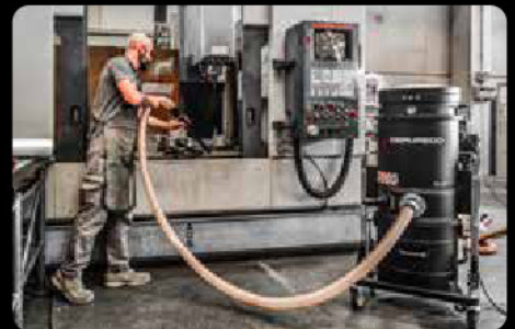
Sammlung von Metallspänen aus CNC-Maschinen
